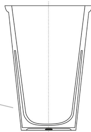
Isolierende Struktur mit doppelten Wänden.
